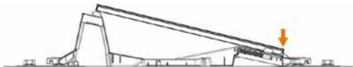
**Modulmontage Schritt 1:** Photovoltaik Modul am Anschlag der Hauptstruktur flach anstellen
